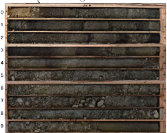
ボーリングコア写真 (m) (ボーリング No.4)
